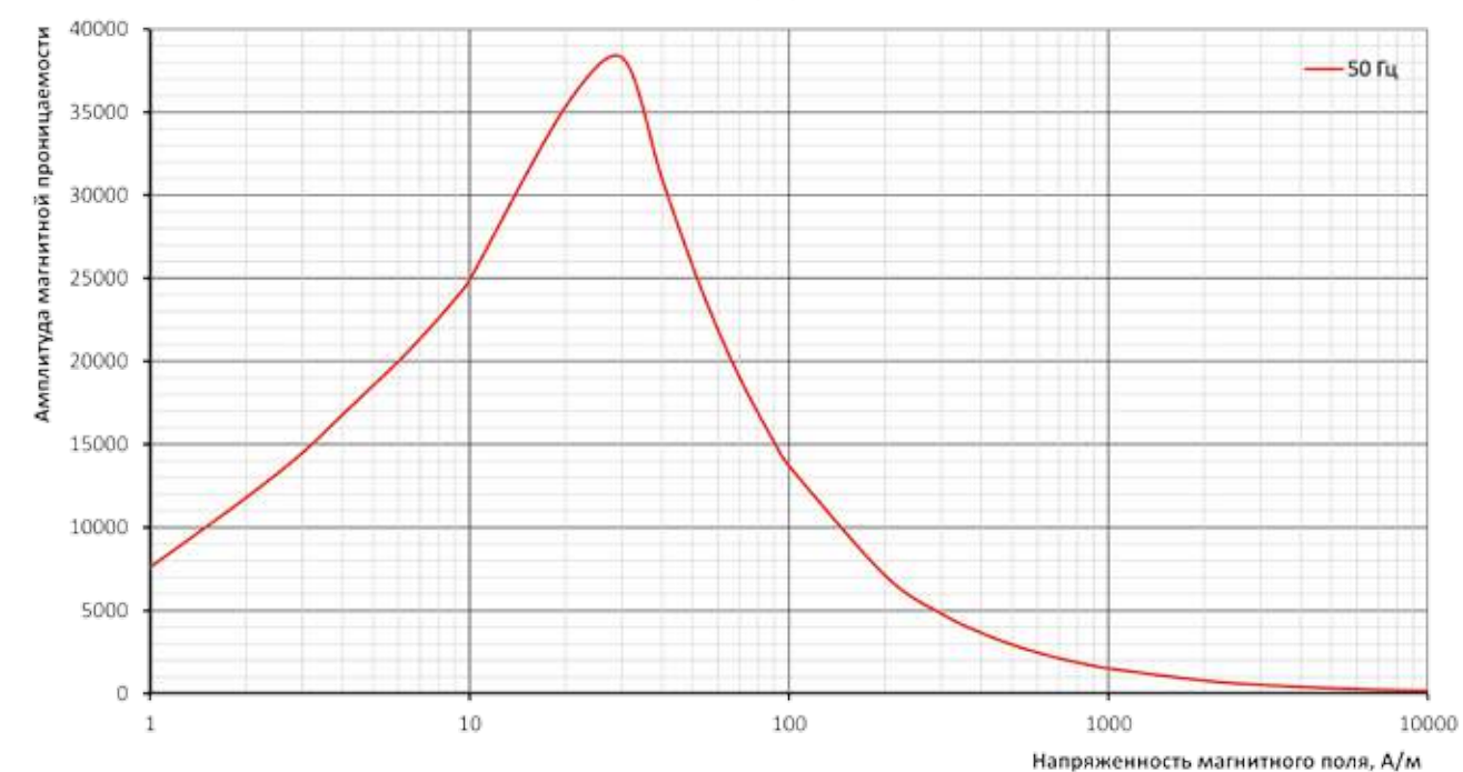
Амплитуда магнитной проницаемости NV35S-130, 0,35 мм
